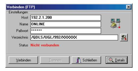
Die Zugangsdaten aus den Optionen sind voreingestellt. Im Feld Verzeichnis ist der Upload – Pfad eingetragen. Klicken Sie auf *Verbinden*, um den Dateitransfer zu starten. Falls Probleme auftreten, können die Fehlermeldungen mit *Details* sichtbar gemacht werden.
